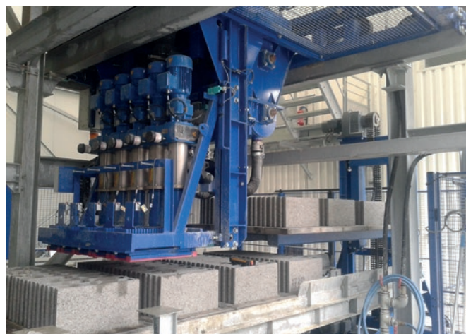
Urządzenie do dozowania i napełniania otworów w bloczkach pianką Air'Mousse.
