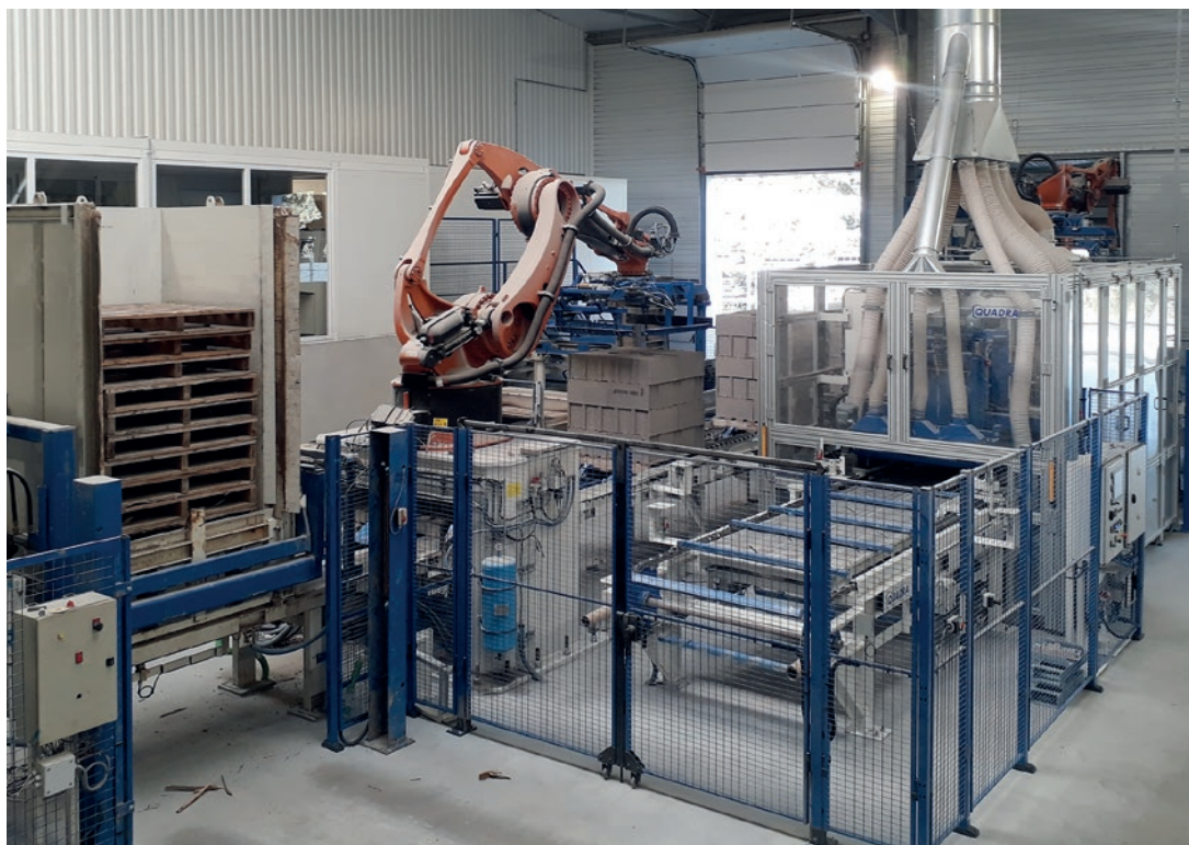
Czteroosiowy robot paletyzujący Kuka typu KR 700 PA.
