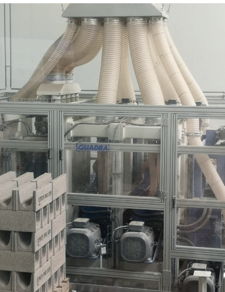
System odsysania i przetwarzania pyłu dla ochrony obszaru obróbki.
