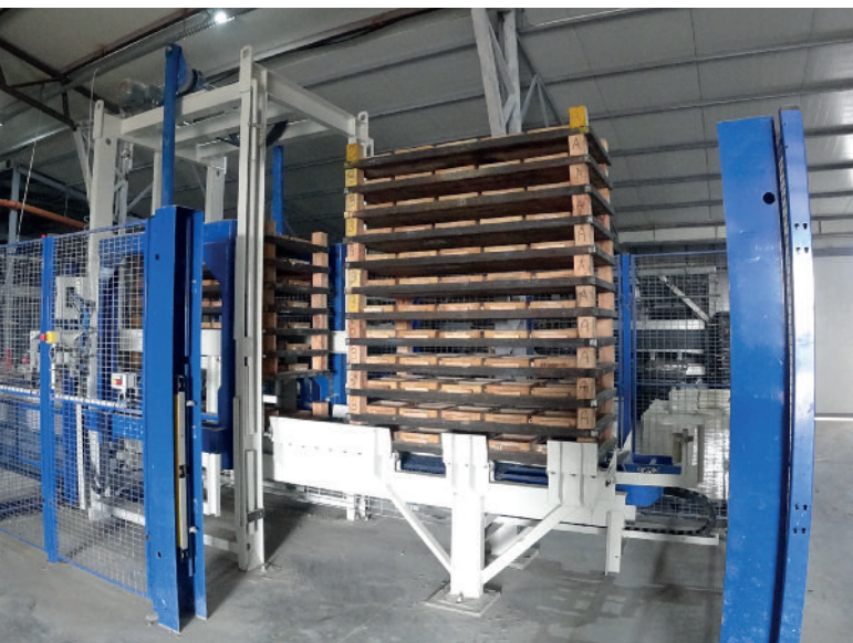
Winda piętrująca i rozpiętrowująca: system manipulowania i transportu dostarczony przez firmę Quadra.
