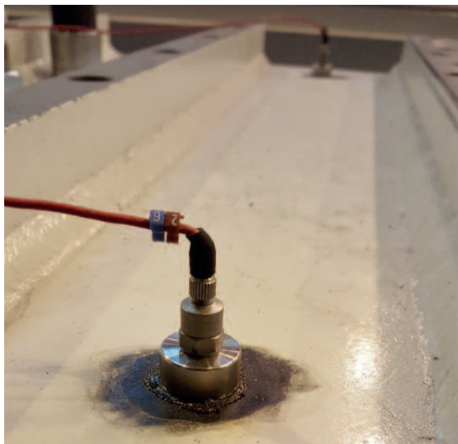
Czujniki przyspieszenia i fotokomórki laserowe.
